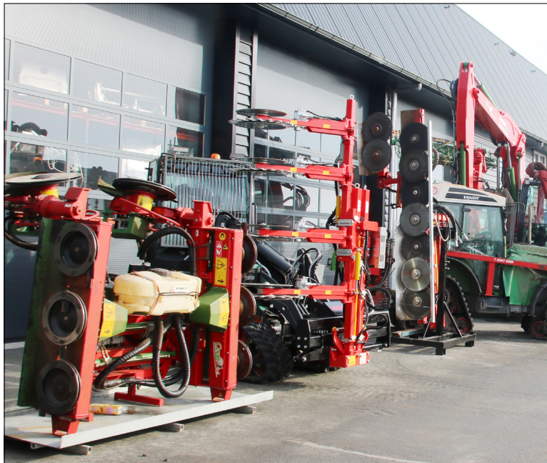
Inmiddels beschikt het loonwerkbedrijf over een reeks van machines om mechanisch te snoeien. Van een koppensnoeier tot de laatste aanwinst van een venstersnoeier. FruitMedia
