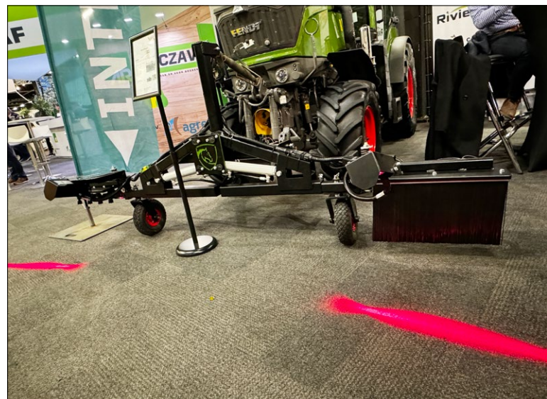
Met behulp van de spotspray techniek wordt er alleen herbicide gespoten als er daadwerkelijk onkruid staat.
