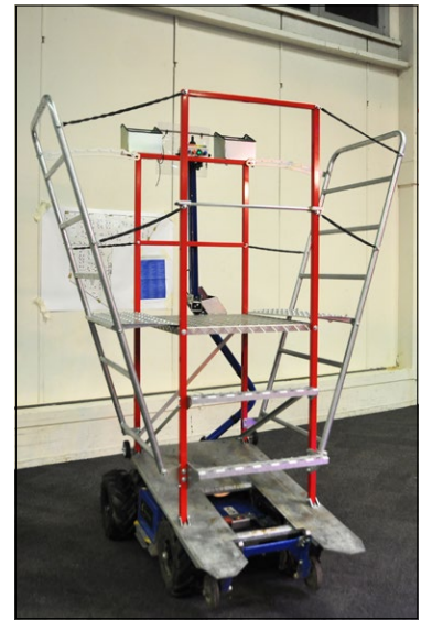
Met vier bouten kan een werkplateau op de LADY worden gemonteerd. Arjan de Bruine
