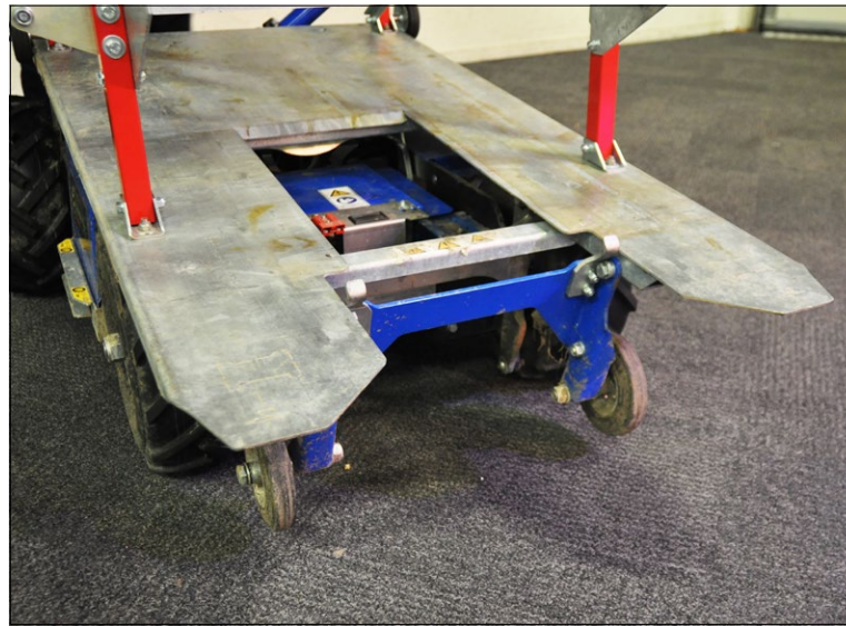
Met het gepatenteerde lossysteem (steunwielen met beugels) kan ook op een helling kisten worden gelost. Arjan de Bruine
