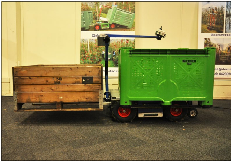
Voorop de LADY kunnen twee vorken worden gemonteerd voor maximaal twee lege voorraadbakken. Arjan de Bruine
