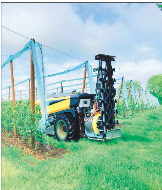
De AgBot 2.055W3 is een basismachine waar modules voor diverse werkzaamheden aan worden gehangen. De machine zal echter vooral voor de gewasbescherming worden gebruikt.
