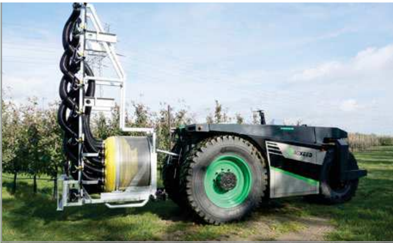
De strakke AgBot 2.055W3 is met de aangebouwde ventilator, en in de nabije toekomst met opgebouwde tank, erg compact. Het voorwiel kan 60 graden draaien, waardoor de draaicirkel kort is. Bert van Sonsbeek
