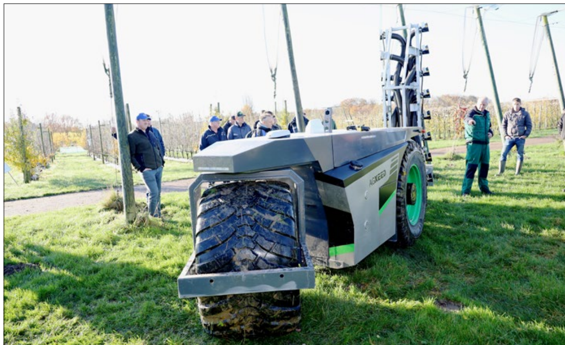
Dankzij de grote banden is de druk op de grasmat kleiner dan met een traditionele trekker met spuit.
